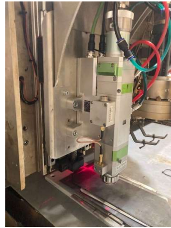
Figuur 2: Opbouw van de lasersnijkop
